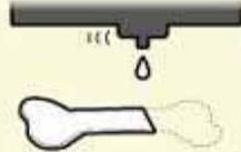
人工骨の材料にインクジェットプリンターで硬化剤を吹き付け、厚さ0.1~0.2mmの板状に加工
