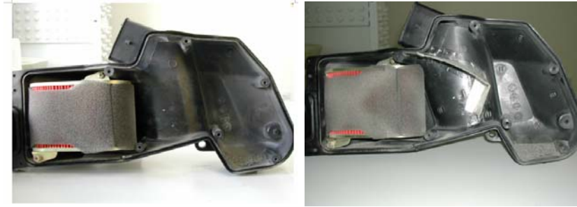
無氣流導板式空氣濾清器粉塵捕捉測試量
